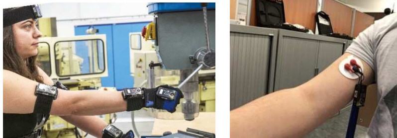
Figure A1. Centrale d'acquisition biomécanique et électromyographique CAPTIV.
