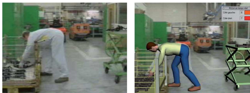
Figure 13 Observation de l'activité réelle de maintenance, évaluation posturale et de la contrainte biomécanique de l'activité à l'aide du mannequin numérique 3D reconfigurable
