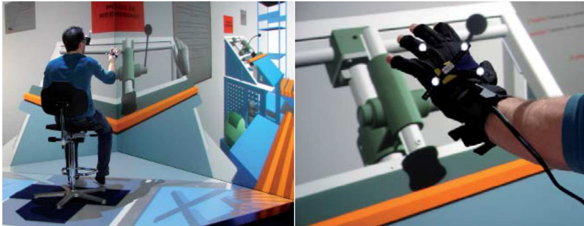
Figure A8. Système de capture de mouvements et récupération de la gestuelle des doigts à l'aide de gants connectés
