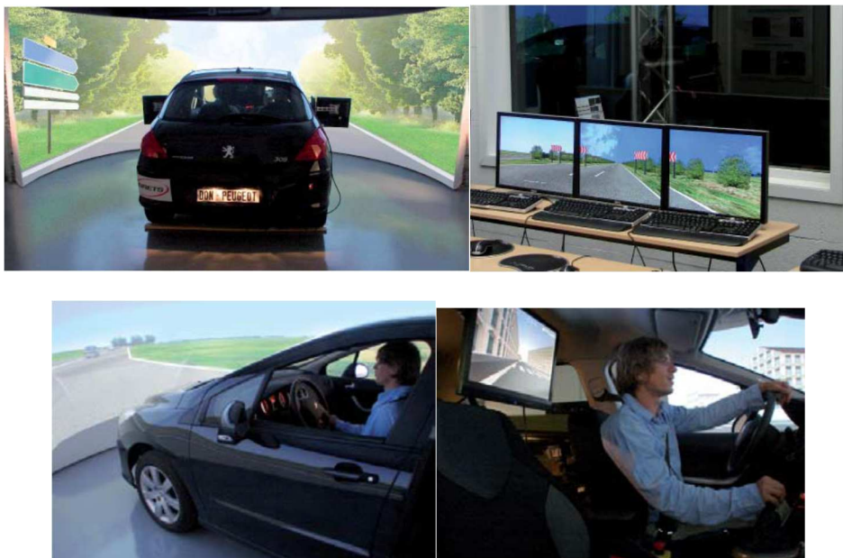
Figure A5. Simulateur d'activité de conduite automobile, avec un système de projection panoramique, une sonorisation spatialisée et un véhicule réel.
