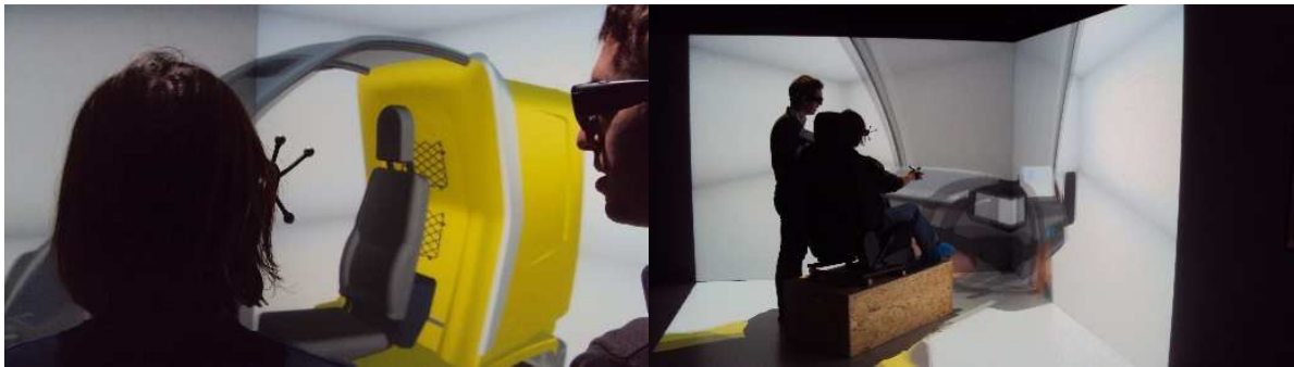
Figure A6. Plateforme de réalité virtuelle : système de visualisation à trois écrans et sonorisation spatialisée.
